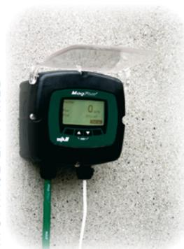
**1** Convertidor y Visualizador montados directamente en el sensor de flujo (Montaje Compacto)
